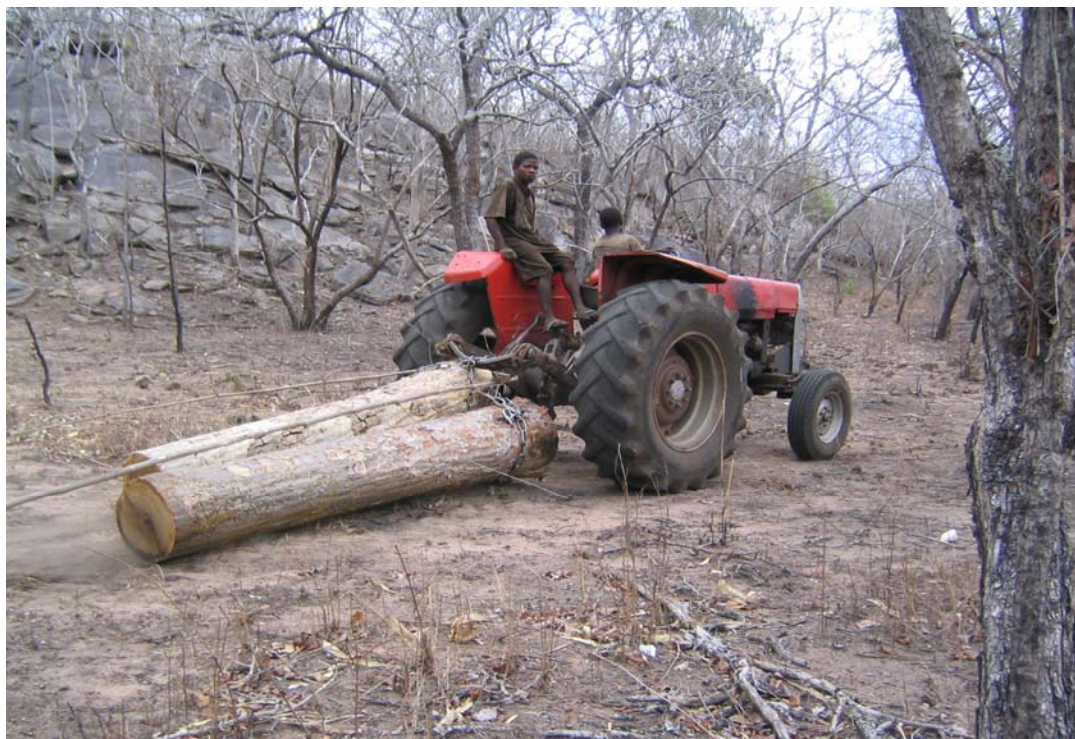
Foto 4: Extracção de toros usando um tractor agrícola (foto, cortesia de R Lautelienan)
