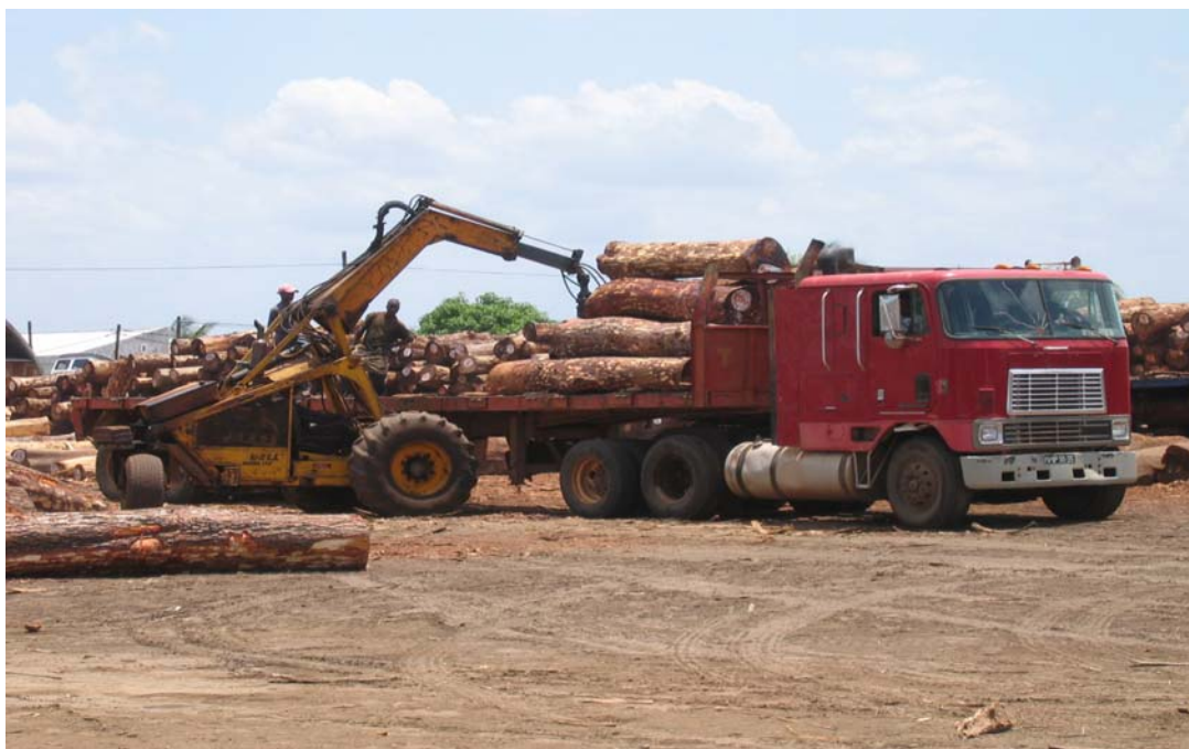
Foto 6 Transporte de madeira II: Carregamento mecanizado de um caminhão-cavalo nas Madeiras Alman, para transporte para o porto de Quelimane
